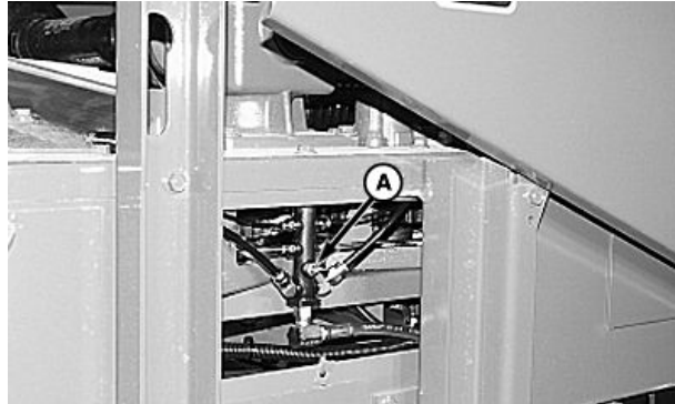
A—Коллектор консистентной смазки
