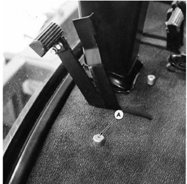
A—Moistener Flush Switch
