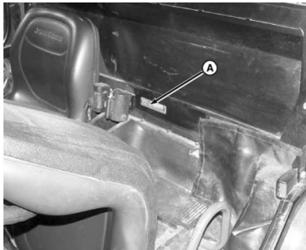
La etiqueta está instalada en la cabina, detrás del conjunto del cinturón de seguridad.
