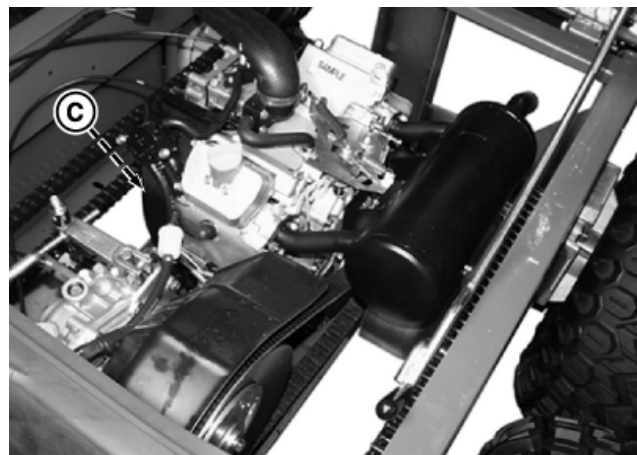
b. Rejillas de admisión de aire del motor (C).
