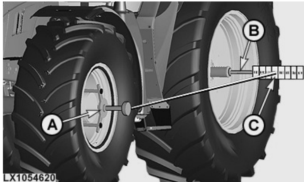
LX1054620—UN—25OCT11 Kontrollera med ett lasermättningsverktyg för hjul
