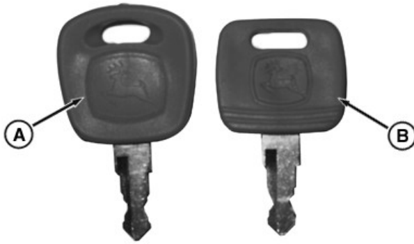
RXA0108294—UN—24JUN10 A—이모빌라이저와의 통신을 위한 칩 및 트랜스폰더를 장착한 키 B—추가 기능이 없는 일반 키
