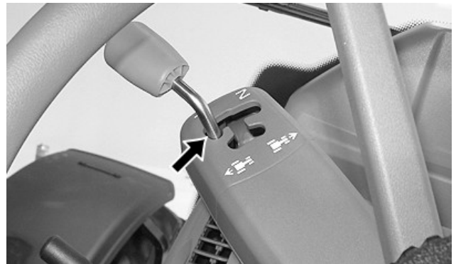
LX372924—UN—27OCT20 AutoPowr™/IVT™에 체결된 주차 잠금장치
