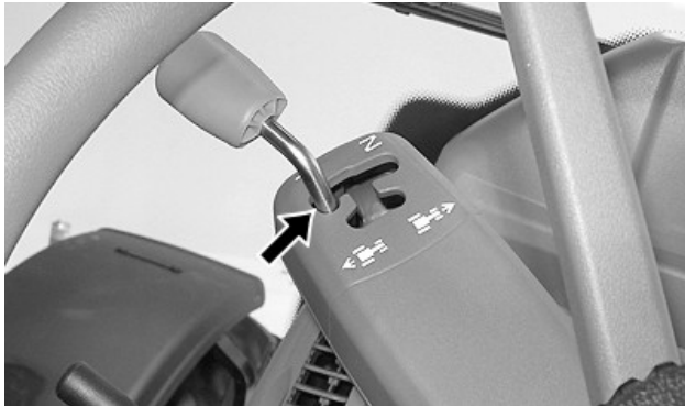
LX372924—UN—27OCT20 AutoPowr™/IVT™에 체결된 주차 잠금장치
