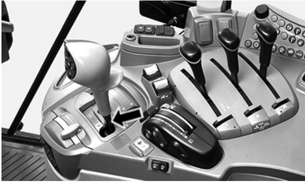
LX315213—UN—05NOV18 Pavarų dėžės blokatorius įjungtas PowrQuad™ / AutoQuad™
