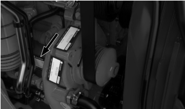
4 cilindų variklių variklio serijos numerio įspaudas
