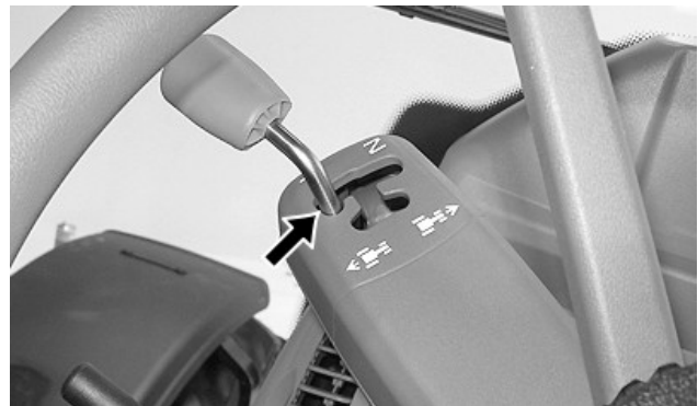
LX372924—UN—27OCT20 Pavarų dėžės blokatorius įjungtas AutoPowr™ / IVT™
