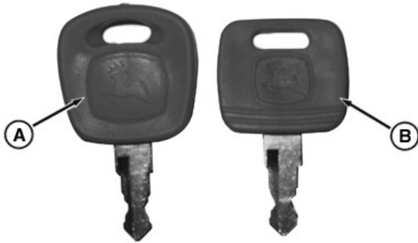
RXA0108294—UN—24JUN10 A —Ključ s čipom i predajnikom za komunikaciju sa imobilizatorom B —Uobičajeni ključ bez dodatne funkcije
