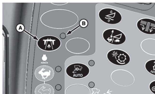
A : Road Transport Disconnect (道路輸送切断) スイッチ
