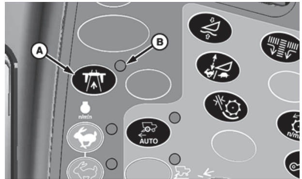
A—Interruttore di sicurezza per la circolazione su strada B—Spia luminosa
