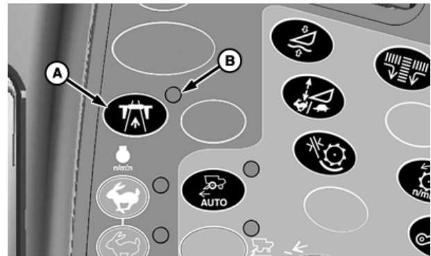
A—Interruptor de desconexión de transporte por carretera B—Luz testigo
