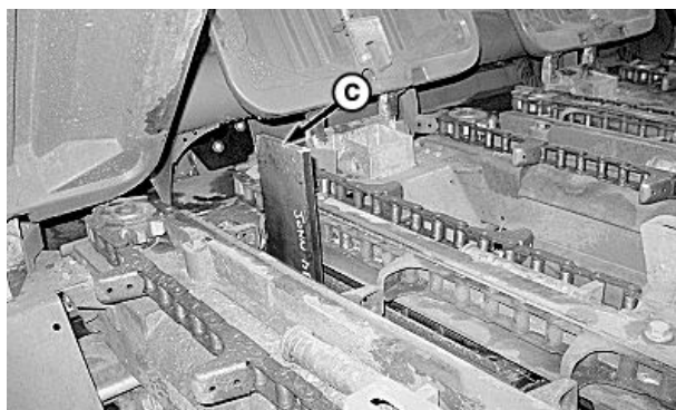
拆卸图中所示左侧锁紧螺母
