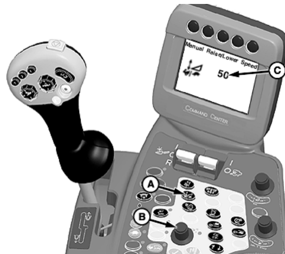
A—Contacteur de réglage de la vitesse de réponse/sensibilité de la chambre d'alimentation B—Cadran de sélection C—Vitesse de réponse
