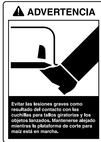
F - Adhesivo de seguridad del cabezal para maíz con picador
