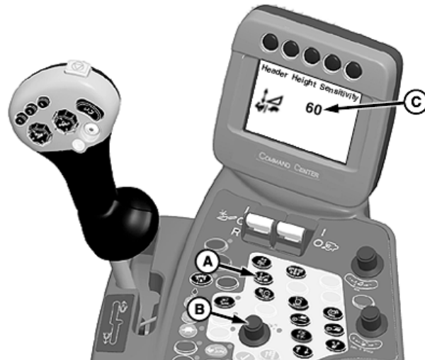
A—Contacteur de réglage de la vitesse de réponse/sensibilité de la chambre d'alimentation B—Cadran de sélection C—Sensibilité
