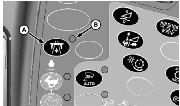
A—Interruttore di sicurezza per la circolazione su strada B—Spia luminosa
