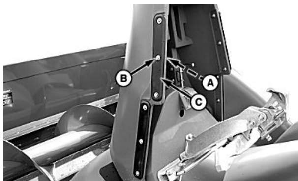
A—Uzgrieznis un paplāksne B—Skrūve un paplāksne C—Nodilusi strēmele
