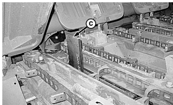
Attēlota kreisās puses noturošā uzgriežņa noņemšana
