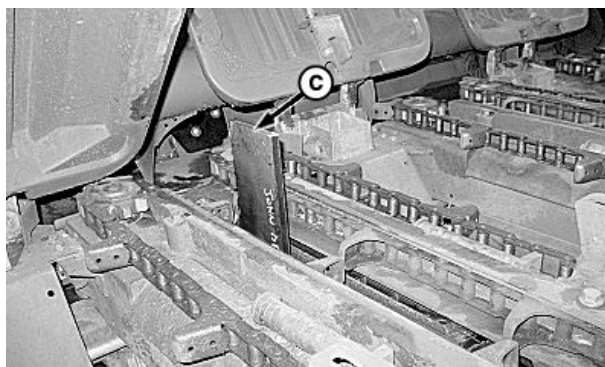
Απεικονίζεται η αφαίρεση του αριστερού παξιμαδιού συγκράτησης
