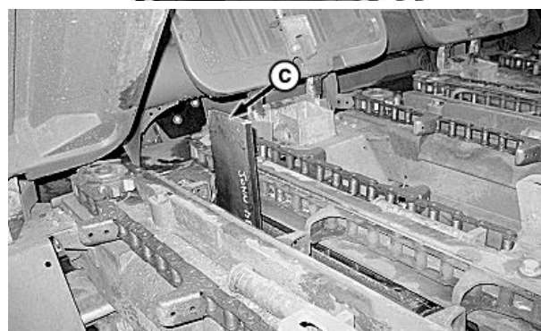
Dépose de l'écrou de fixation gauche
