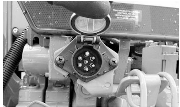
7-контактная розетка на тракторе
