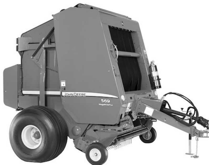
569 с подборщиком MegaWide™ Plus, устройством обвязки рулона сеткой COVER-EDGE™ и доп. выталкивателем
