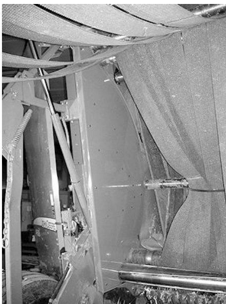
Показана изнашиваемая обшивка главной рамы
