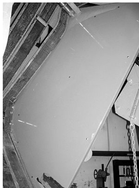
Показана изнашиваемая обшивка рамы заслонки
