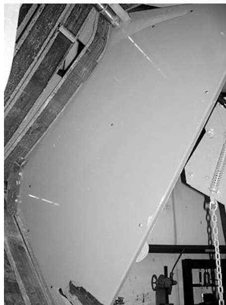
Panel para desgaste de portón/bastidor
