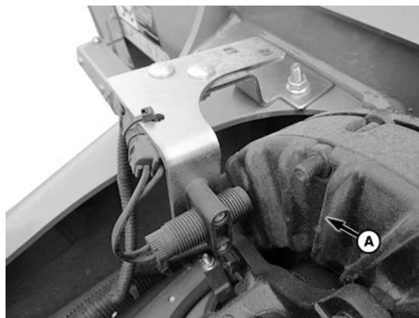
Visualización del sensor de la TDF (540 r/min)
