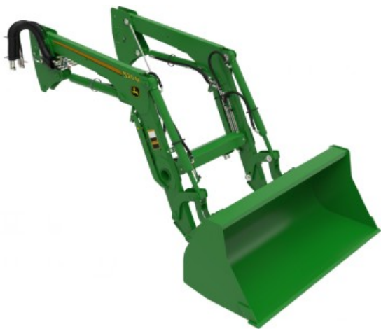
APY88261—UN—08DEC23 520M өздігінен тегістелмейтін жүктеуші көрсетілген
