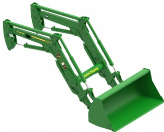
APY93020—UN—25JAN24 540M механикалық өздігінен тегістейтін жүк тиегіші көрсетілген
