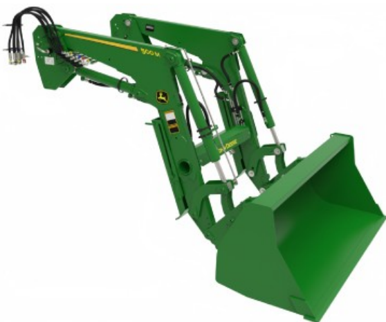
APY88260—UN—08DEC23 500 м өздігінен тегістелмейтін жүктеуші көрсетілген
