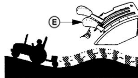
Polohová regulace hřídele zvedacího ústrojí závěsu
