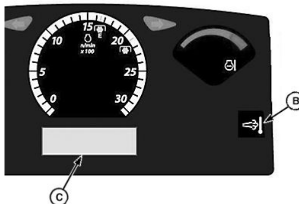
Probíhá čištění filtru v zaparkovaném stavu
