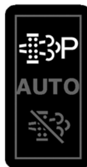
Spínač čištění filtru motoru – režim Parkování
