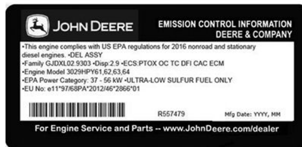
Příklad štítku emisí motoru
