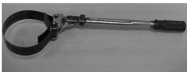
Demontáž hydraulického filtru / montážní nástroj
