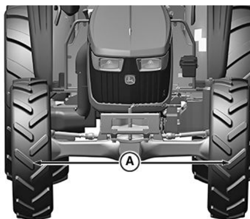
A—Rozměr pro měření sbíhavosti kol přední hnací nápravy
