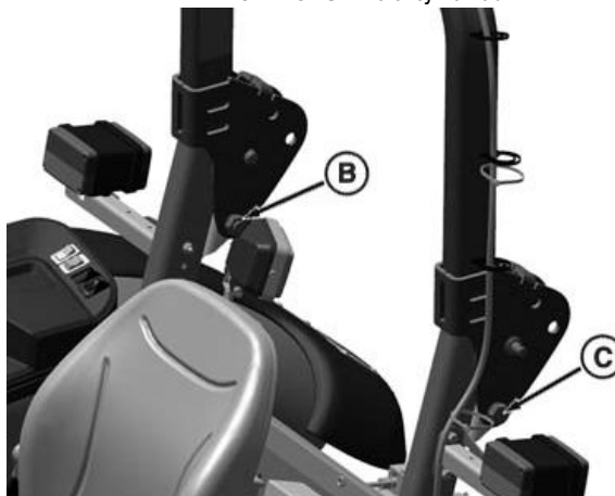
Ugradnja svornjaka i matica
