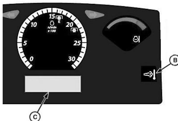
Postupak parkirnog čišćenja filtera u toku
