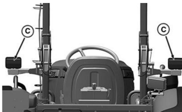
Semnalizatoarele de direcție din spate, numai pentru 5050E, 5058E, 5067E și 5075E
