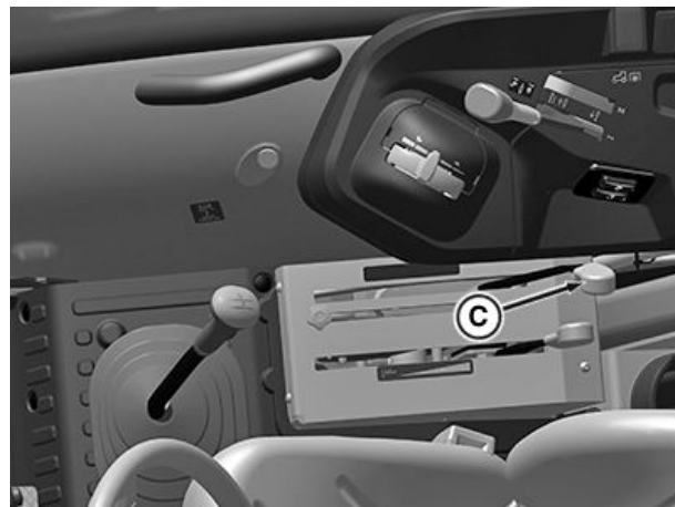
Maneta de control pentru IOOS, 5050E, 5058E, 5067E și 5075E
