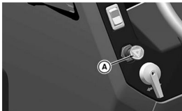
Comutatorul de avarie numai pentru 5050E, 5058E, 5067E și 5075E
