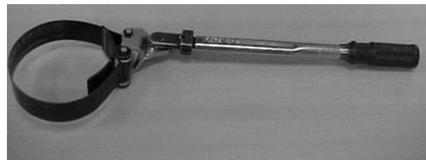
Instrument de demontare / montare a filtrului hidraulic
