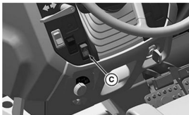
Comutatorul de avarie doar pentru 5058E, 5067E și 5075E
