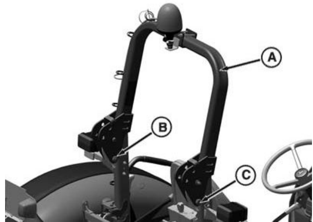
Structura ROPS fixă — Poziția de funcționare
