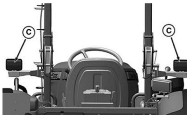
Luminile de semnalizare a virajului din spate, numai pentru 5050E, 5058E, 5067E și 5075E
