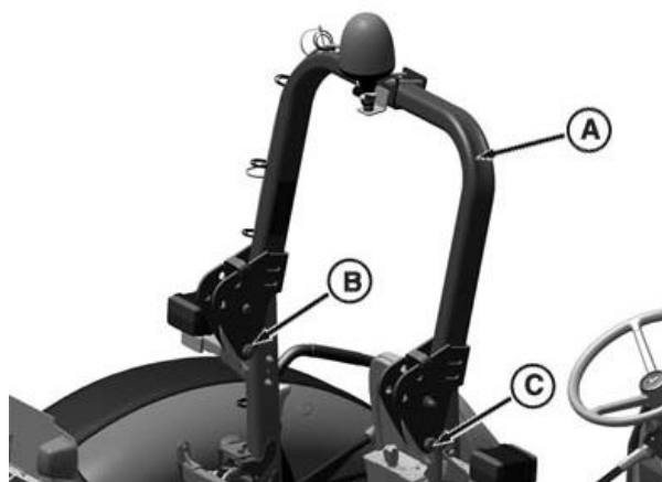
Structura ROPS fixă — Poziția de operare
