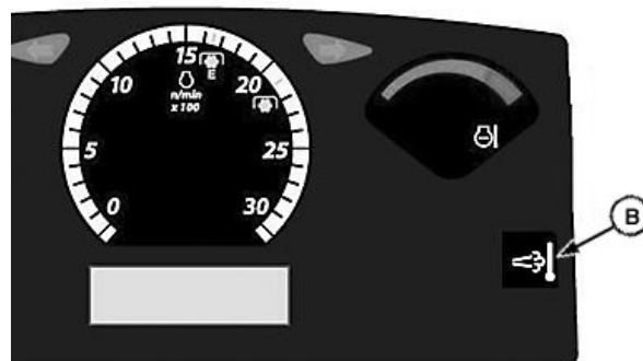
Comutatorul modului de curățare a filtrului de evacuare
