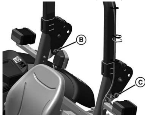
Structura ROPS fixă — Poziția de funcționare
