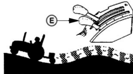
Comando di posizione del sollevatore
