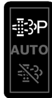
Interruttore di pulizia filtro di scarico - Modalità di stazionamento
