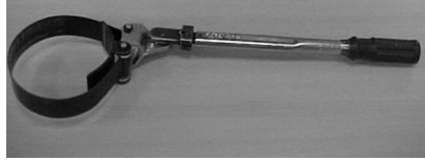
Attrezzo per la rimozione / installazione del filtro idraulico
