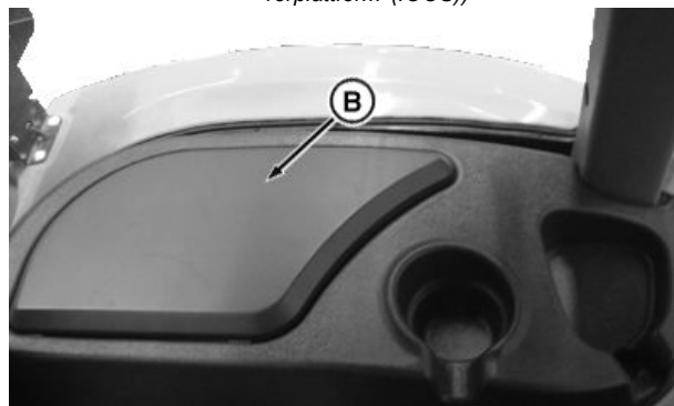
Einbauort des Sicherungskastens (Kabine)
