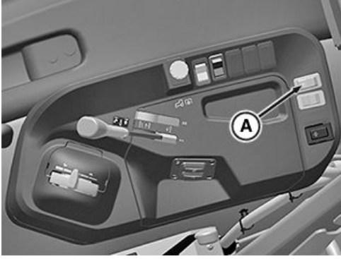
Yalnızca 5058E, 5067E ve 5075E için Çalışma Lambası Şalteri
