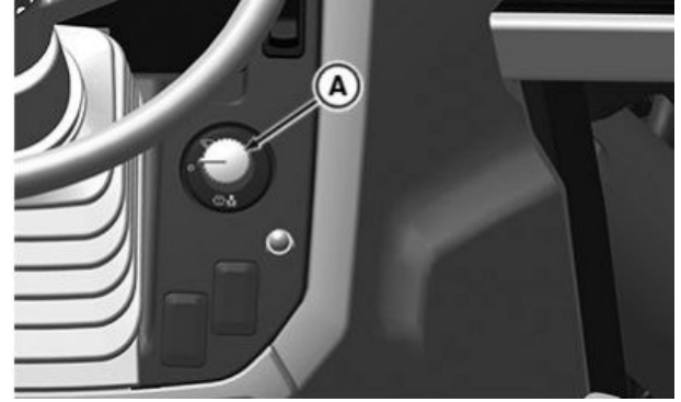
Yalnızca 5058E, 5067E ve 5075E için Ön Cam Sileceği Şalteri
