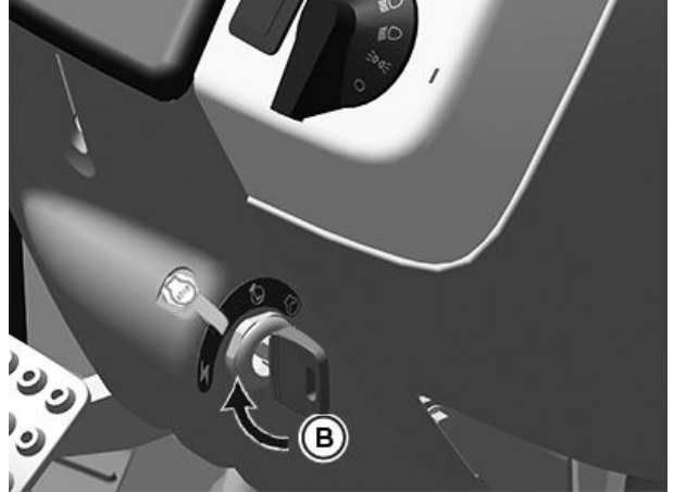
Kontak Anahtarını Saat Yönünde Döndürün - Kabinli
