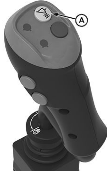
A—Ön Yükleyici Süspansiyonu Düğmesi
