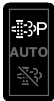
Rofi fyrir hreinsun útblásturssíu - stöðugírsstilling
