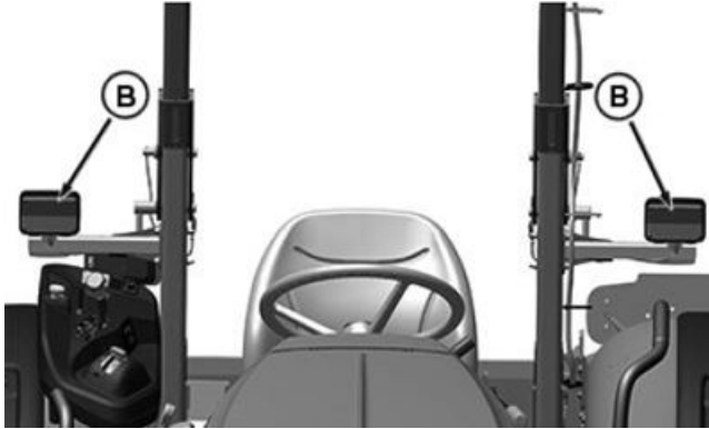
Clignotant avant gauche pour les tracteurs 5050E, 5058E, 5067E et 5075E uniquement
