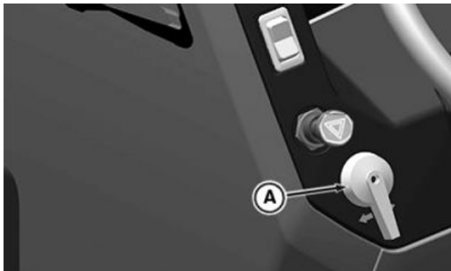
Interrupteur des clignotants pour les tracteurs 5050E, 5058E, 5067E et 5075E uniquement
