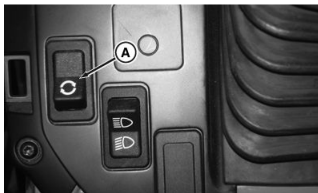
Contacteur de défilement/sélection (cabine illustré)
