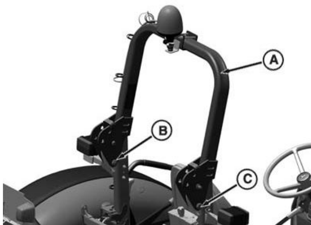
Arceau/cadre de sécurité fixe — Position de fonctionnement
