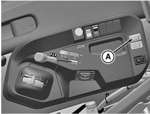
Interrupteur de phares de travail pour les tracteurs 5050E, 5058E, 5067E et 5075E uniquement
