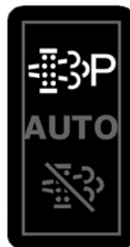
Contacteur de nettoyage du filtre à gaz d'échappement - Mode machine en stationnement
