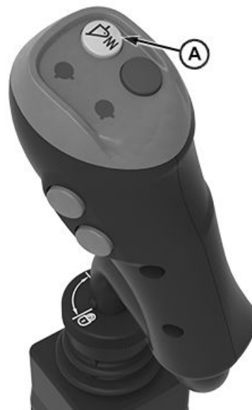
A—Bouton de suspension du chargeur frontal
