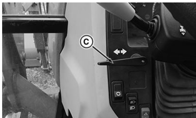
Interrupteur des clignotants pour les tracteurs 5058E, 5067E et 5075E uniquement
