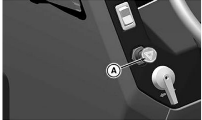
Interrupteur des feux de détresse pour les tracteurs 5050E, 5058E, 5067E et 5075E uniquement
