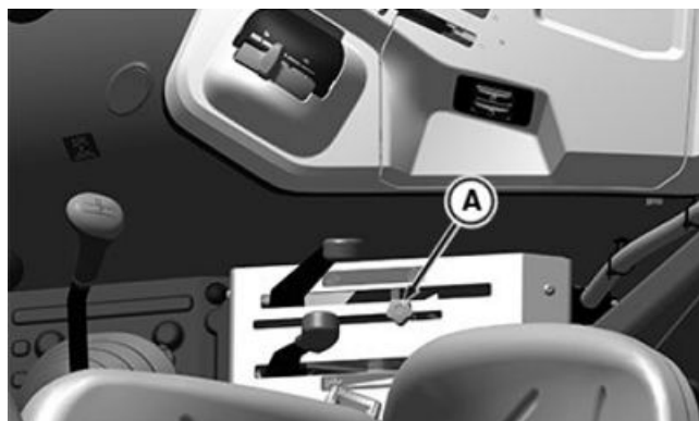
Leviers de commande sur tracteurs à plate-forme de conduite isolée, 5050E, 5058E, 5067E et 5075E
