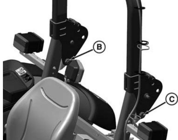
Arceau/cadre de sécurité fixe — Position de fonctionnement
