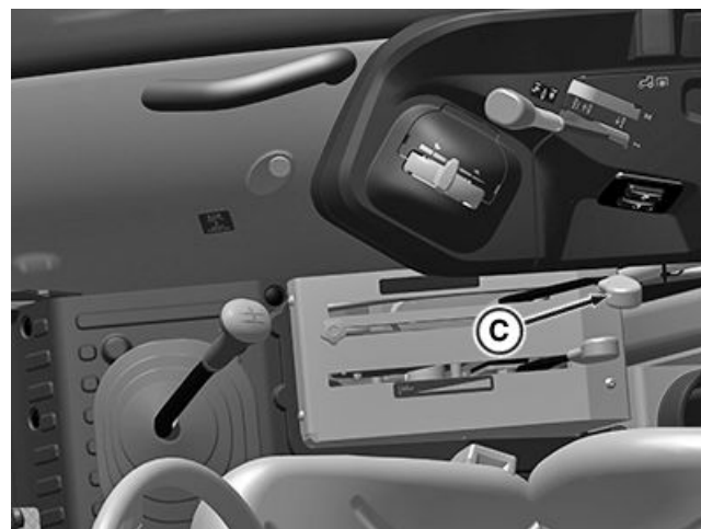
Levier de commande pour plate-forme de conduite isolée, 5050E, 5058E, 5067E et 5075E
