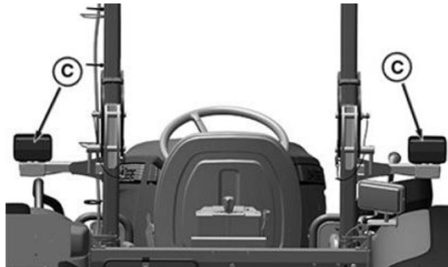
Clignotants arrière pour les tracteurs 5050E, 5058E, 5067E et 5075E uniquement
