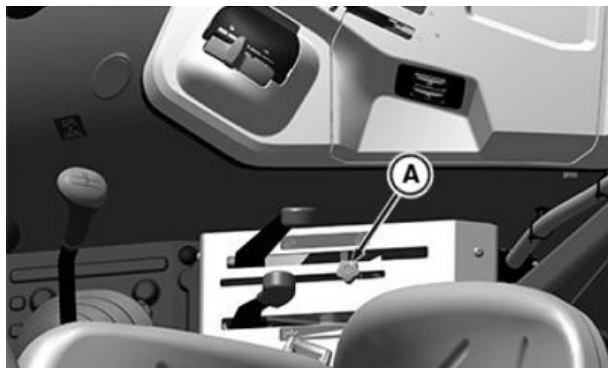
Upravljačke ručice za IOOS, 5050E, 5058E, 5067E i 5075E
