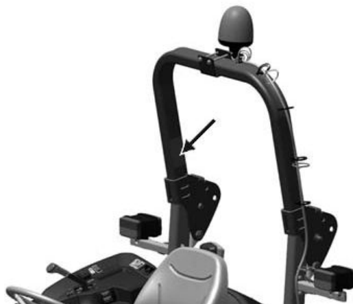
Desna strana ROPS-a—IOOS (traktor bez kabine)
