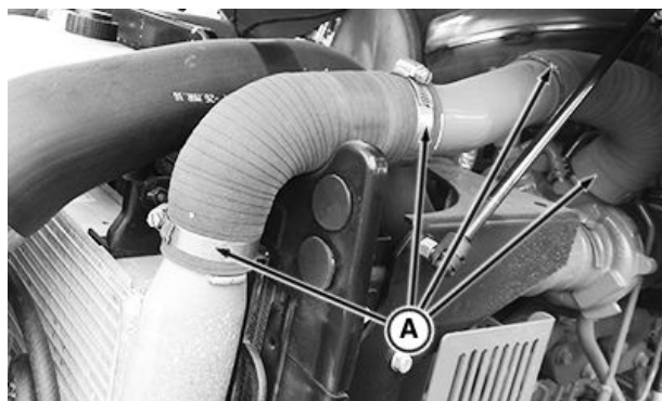
Spoj međuhladnjaka i turboprehranjivača
