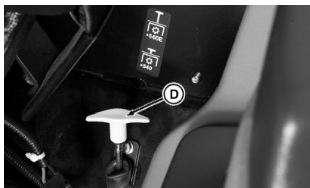
Ručica za prebacivanje priključnog vrtila 540/540E
