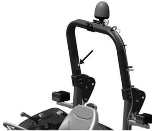
Desna strana ROPS-a—IOOS (traktor bez kabine)
