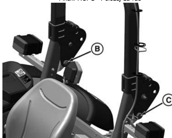
Ugradnja svornjaka i matica
