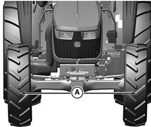
A—Растојание во геометријата на MFWD оската
