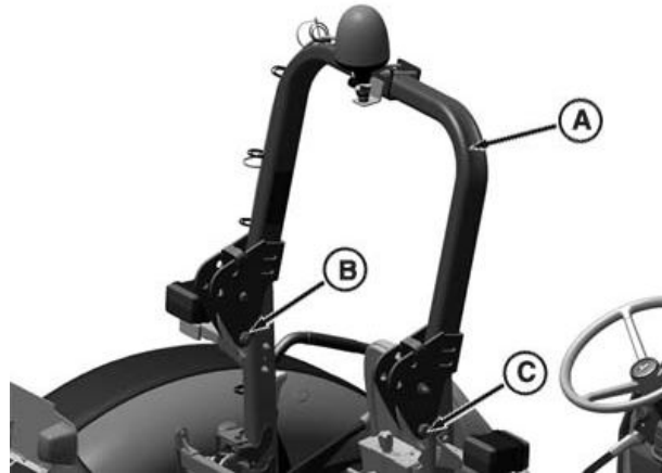
Фиксиран ROPS—Работна положба
