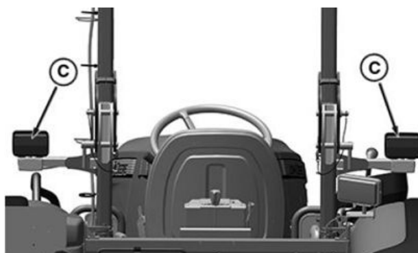
Задни светла за трепкач за 5050E, 5058E, 5067E и само за 5075E
