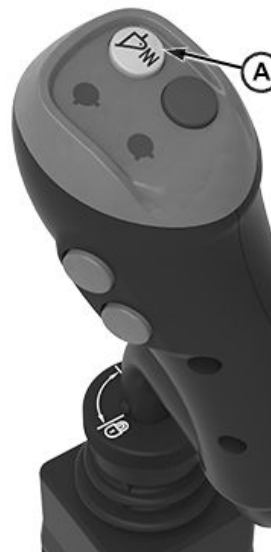
A—Копче за суспензија на преден натоварувач
