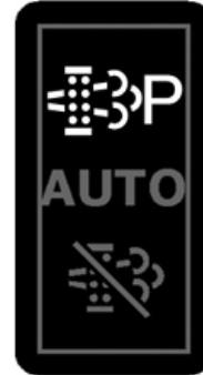
Прекинувач за чистење на филтерот на издувни гасови - Паркирен режим
