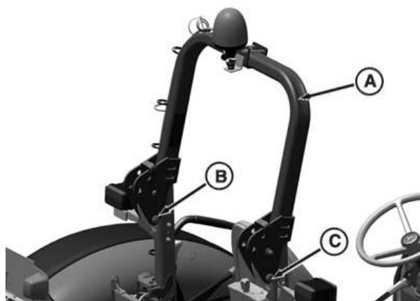
Фиксиран ROPS—Работна положба
