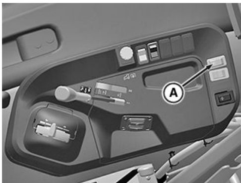
Прекинувач за работно светло за 5050E, 5058E, 5067E и само за 5075E
