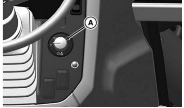
Yalnızca 5058E, 5067E ve 5075E için Ön Cam Sileceği Şalteri
