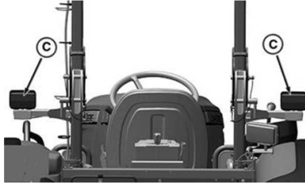
Yalnızca 5050E, 5058E, 5067E ve 5075E için Arka Dönüş Lambaları
