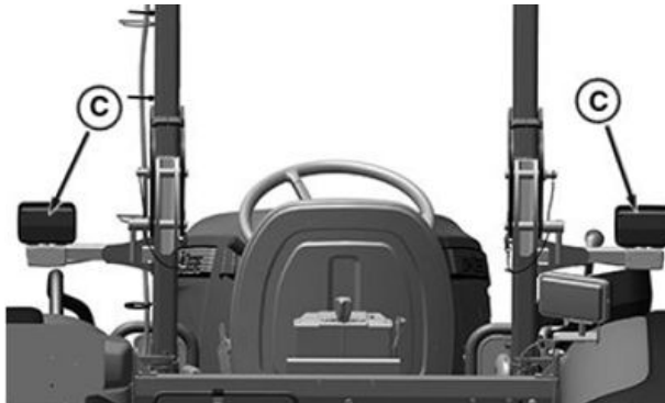
Yalnızca 5050E, 5058E, 5067E ve 5075E için Arka Dönüş Sinyal Lambaları
