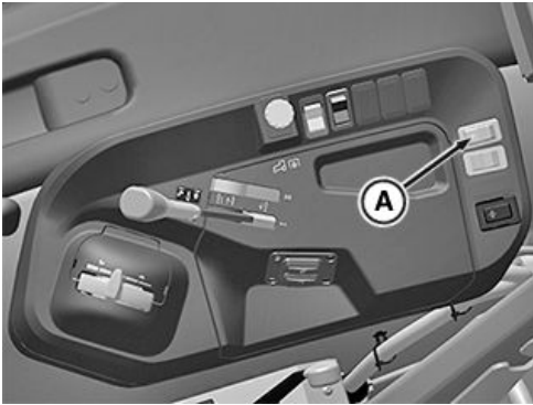
Yalnızca 5050E, 5058E, 5067E ve 5075E için Çalışma Lambası Şalteri
