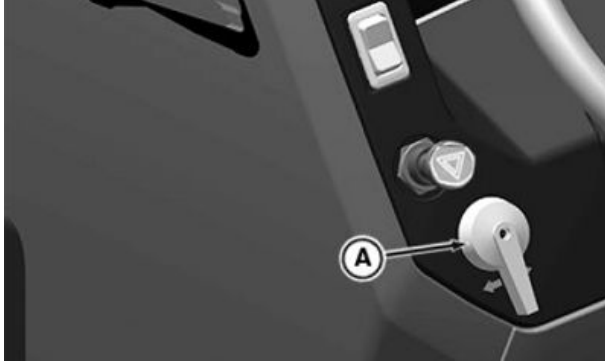
Yalnızca 5050E, 5058E, 5067E ve 5075E için Dönüş Sinyali Şalteri
