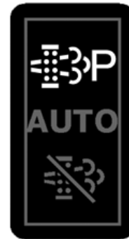
Interruptor de limpieza del filtro de escape - Modo estacionado
