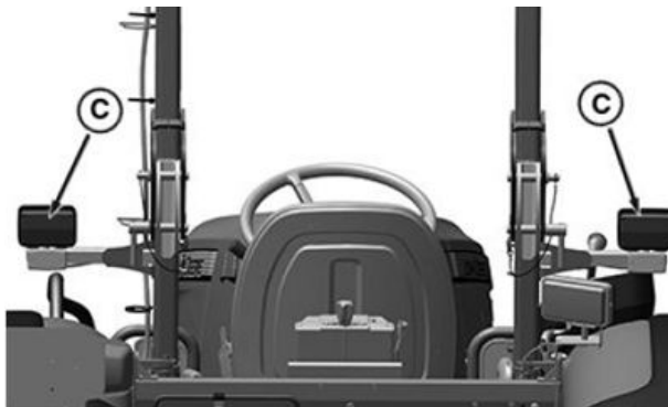
Intermitentes traseros, solo para los modelos 5050E, 5058E, 5067E y 5075E
