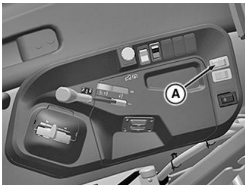
Interruptor de faro de trabajo, solo para modelos 5050E, 5058E, 5067E y 5075E
