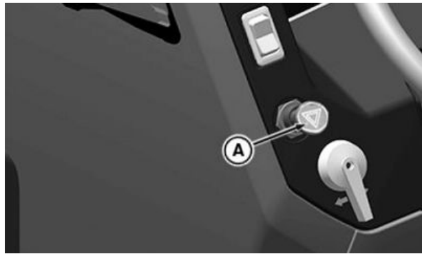
Interruptor de luces de emergencia, solo para modelos 5050E, 5058E, 5067E y 5075E
