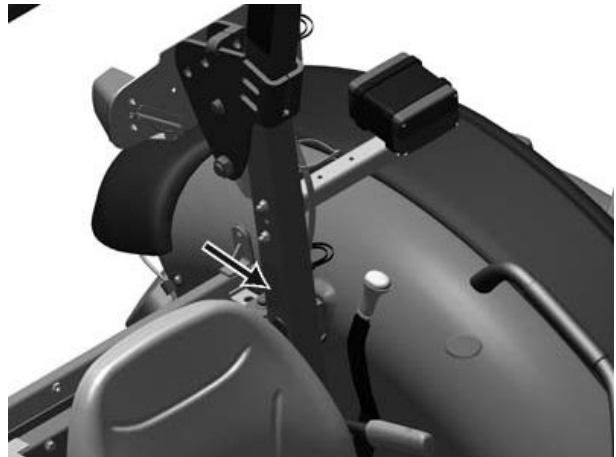
Lado izquierdo de la estructura protectora contra vuelcos — Plataforma de conducción abierta aislada
