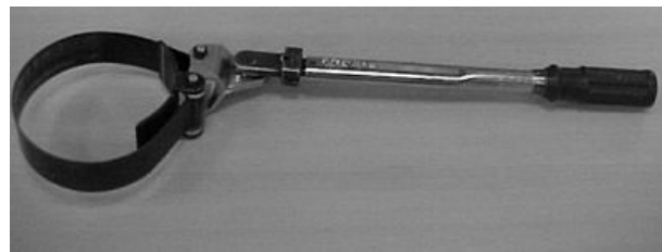
Extracción del filtro hidráulico / llave para filtro de aceite
