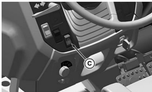
Interruptor de luces de emergencia solo para 5058E, 5067E y 5075E
