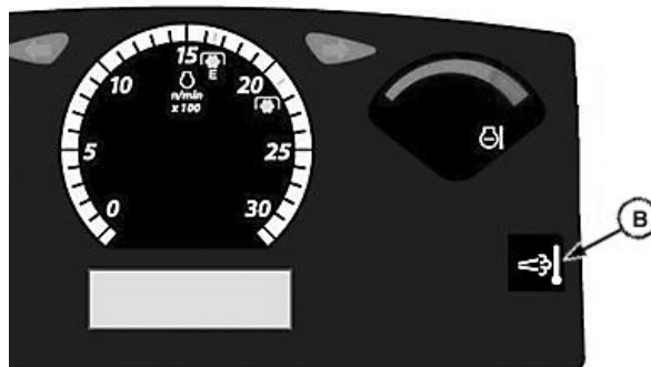
Ключ за режим на почистване на филтъра за отработените газове
