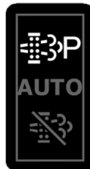
Ключ за почистването на филтъра за отработените газове – Режим "в паркирано състояние"
