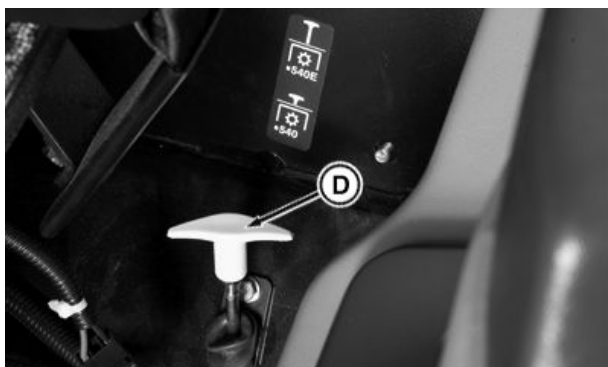
Dźwignia przełączania WOM 540/540E
