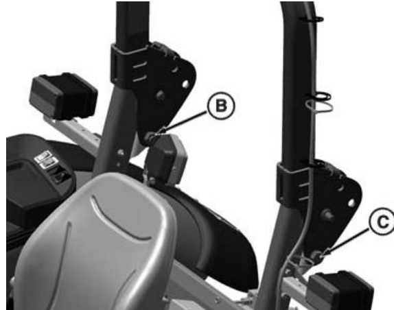
Zainstalowanie śrub i nakrętek
