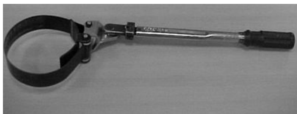
Demontaż filtra hydraulicznego / narzędzie montażowe
