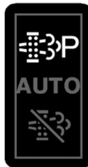
Przełącznik czyszczenia filtra spalin — tryb postojowy
