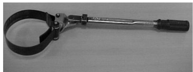
Hidrauliskā filtra noņemšana / instrumenta uzstādīšana
