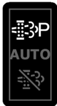
Rofi fyrir hreinsun útblásturssíu - stöðugírsstilling
