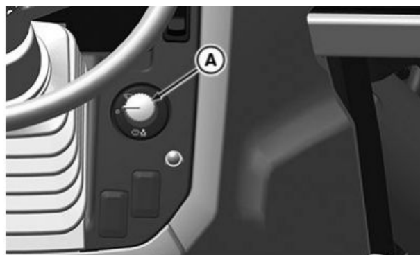
Szélvédő ablaktörő kapcsoló, csak az 5058E, 5067E és 5075E modelleknél
