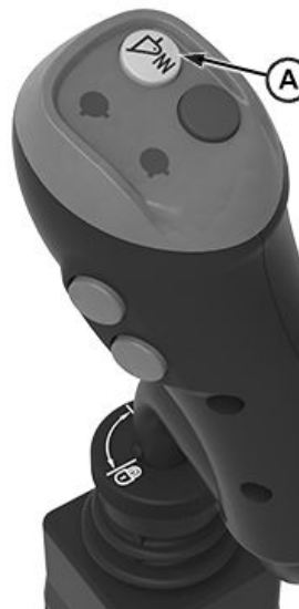
A—Homlokrakodó felfüggesztés gomb
