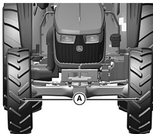
A—Az első tengely kerékösszetartási távolsága
