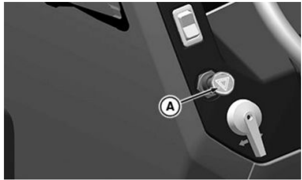
Elakadásjelző kapcsoló, csak az 5050E, 5058E, 5067E és 5075E traktorokon
