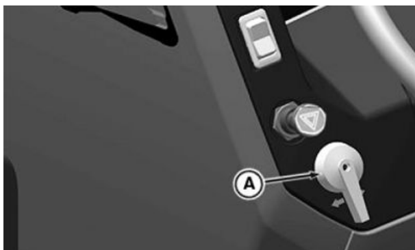
Irányjelző kapcsoló, 5050E, 5058E, 5067E és 5075E traktorok
