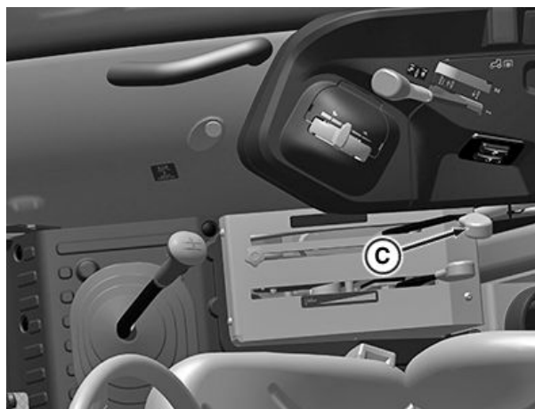
Vezérlő kar, IOOS kivételű 5050E, 5058E, 5067E és 5075E
