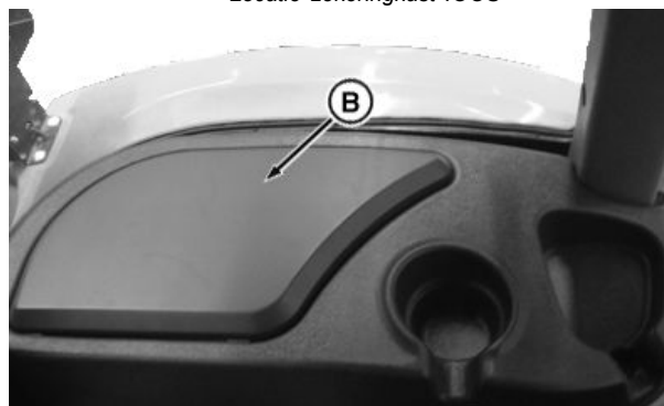
Locatie zekeringkast cabine
