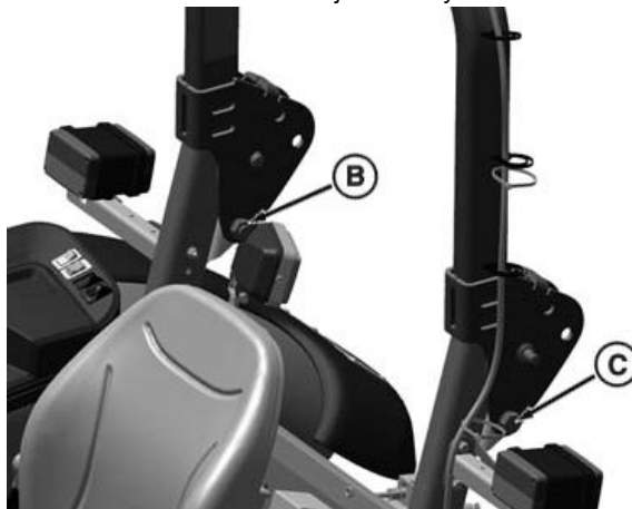
Kuusioruuvien ja muttereiden asennus
