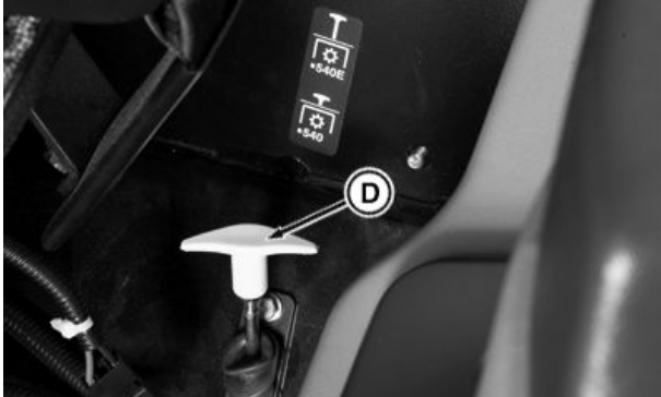
Voimanoton nopeuksien 540/540E vaihdevipu
