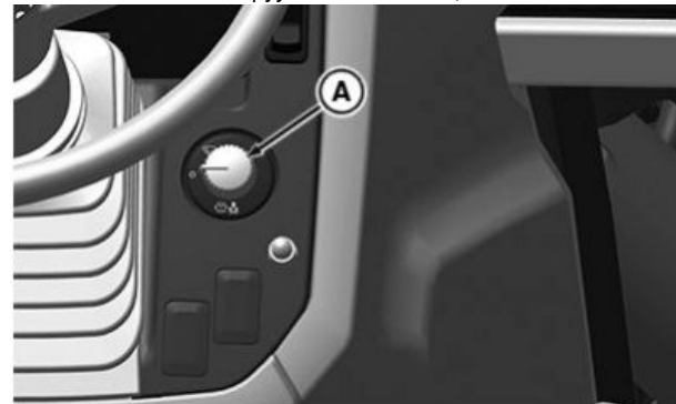
Tuulilasin pyyhkimen katkaisin, vain 5058E, 5067E ja 5075E
