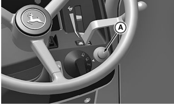
Äänimerkkilaitteen katkaisin, vain 5050E
