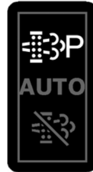
Kontakt til rensemodus for udstødningsfilter - Parkeret modus
