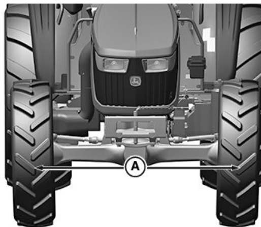
A—Afstand for forhjulsspidsning på mekanisk forhjulstrækaksel
