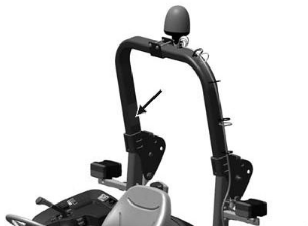
Pravá strana konstrukce ROPS – IOOS (pevná konstrukce ochranného rámu proti převrácení ROPS)
