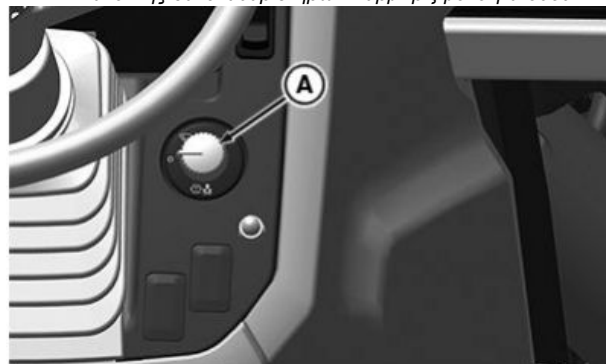
Διακόπτης υαλοκαθαριστήρων παρμπρίζ μόνο για 5058E, 5067E και 5075E
