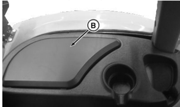
Θέση πίνακα ασφαλειών καμπίνας
