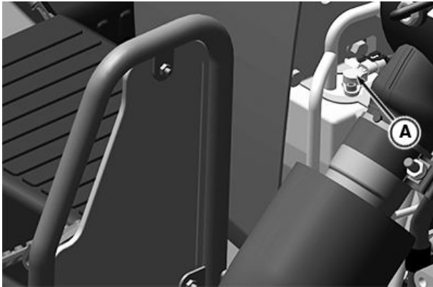
Διακόπτης στάθμης υδραυλικού υγρού φρένων (Απεικόνιση έκδοσης IOOS)
