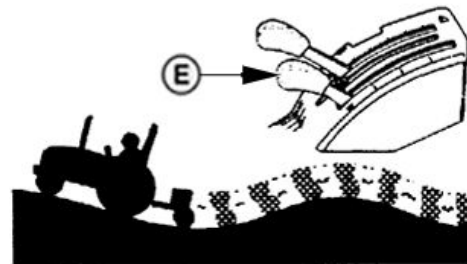
Контрола на положбата на системот за подигнување
