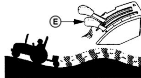
Control de posición del eje elevador
