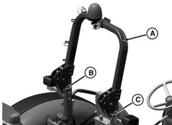
Fiksna konstrukcija ROPS – delovni položaj
