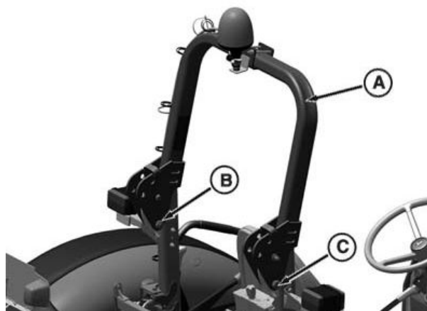
Fiksna konstrukcija ROPS – delovni položaj
