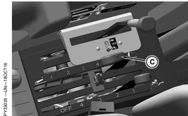
Maneta de control pentru IOOS, doar pentru 5050E
