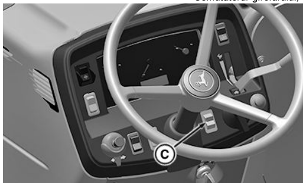
Comutatorul girofarului, doar pentru 5050E
