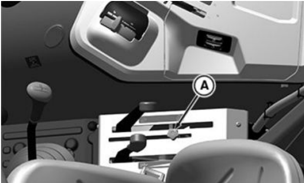
Manetele de comandă pentru IOOS, doar pentru 5058E, 5067E și 5075E
