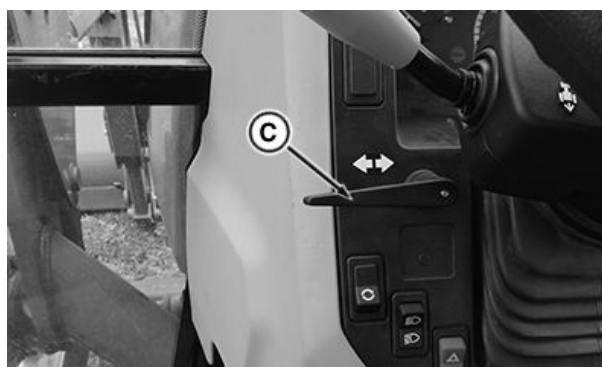
Comutatorul semnalizatoarelor de direcție numai pentru 5058E, 5067E și 5075E
