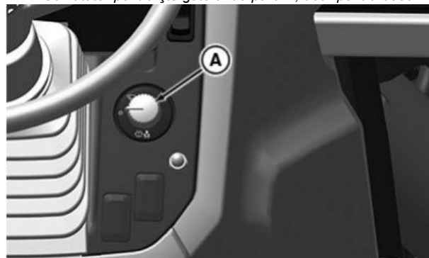
Comutator pentru ștergătorul de parbriz, doar pentru 5058E, 5067E și 5075E
