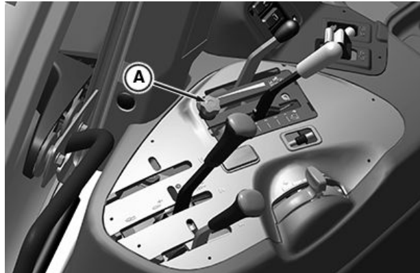
Manetele de comandă pentru cabină, doar pentru 5058E, 5067E și 5075E
