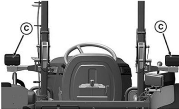
Semnalizatoarele de direcție din spate, doar pentru 5058E, 5067E și 5075E
